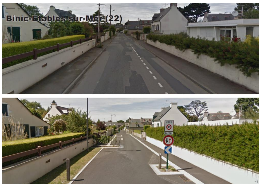
Le végétal pour embellir l'espace public, mais aussi pour maîtriser la vitesse des véhicules en créant des chicanes plantées qui obstruent la vue et rompent l'effet de tunnel. Photos avant-après l'aménagement à Binic-Etables-sur-Mer (22)
